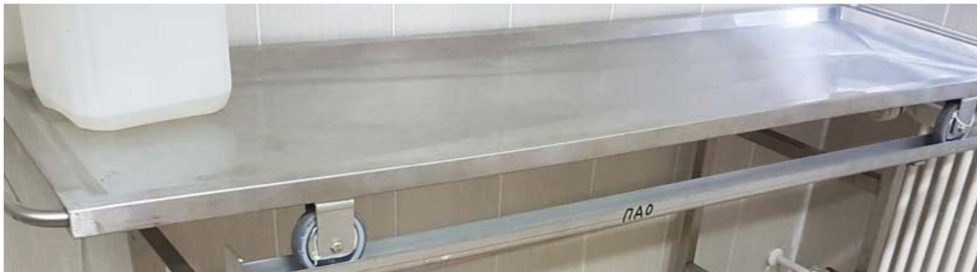
Тележка поддон для загрузки с подкатной тележки на подъемник и с подъемника на стеллаж. Материал рамы - сталь, окрашенная порошковой краской или нержавеющая сталь марки AISI 304. Ложe – НЖС. 4 колеса 50 мм или 8 колес диаметром 100 мм. Грузоподъемность - 150 или 200 кг. Размер (ДхШхВ), мм: 2000x580x120 или 2000x580x170. Вес 10 или 15 кг. Поддон совместим со стеллажами, подъемником и подкатной тележкой марки "ЛТВ". Сертификат соответствия EAC № EAЭС N RU Д-РУ.НВ29.В.07396/20.
