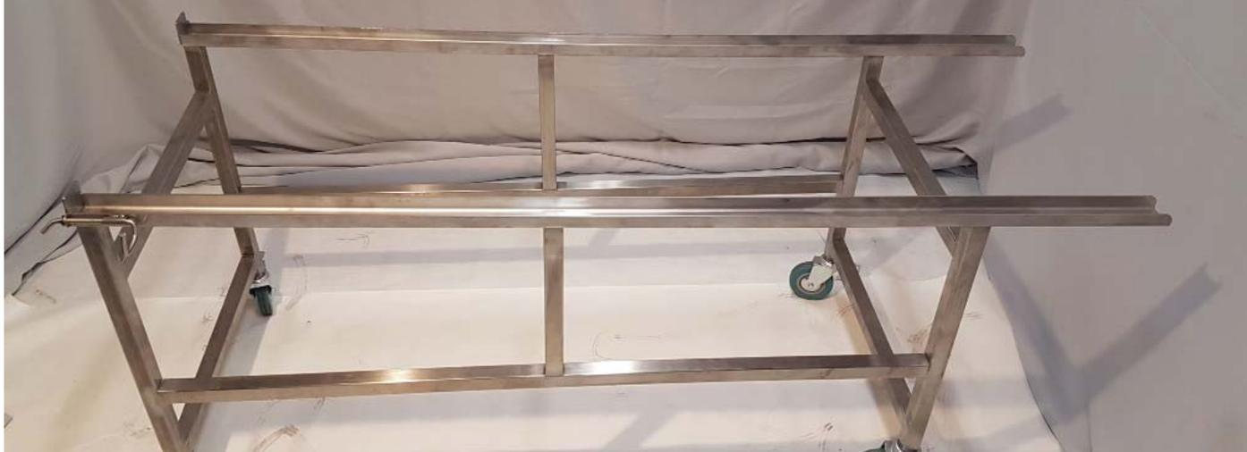
Тележка подкатная. Материал - сталь, окрашенная порошковой краской или НЖС. Рельсы из нержавеющей стали марки AISI 304, ширина рельс 550 мм. 4 колеса диаметром 125 мм. В т.ч. 2 колеса поворотные. Грузоподъемность - 150 кг или 200 кг. Размер (ДхШхВ), мм: 1600х600х700. Вес 20 кг. Тележка совместима со стеллажами, подъемником и поддоном марки "LTV". Сертификат соответствия ЕАС № ЕАЭС N RU Д-РУ.НВ29.В.07396/20.
