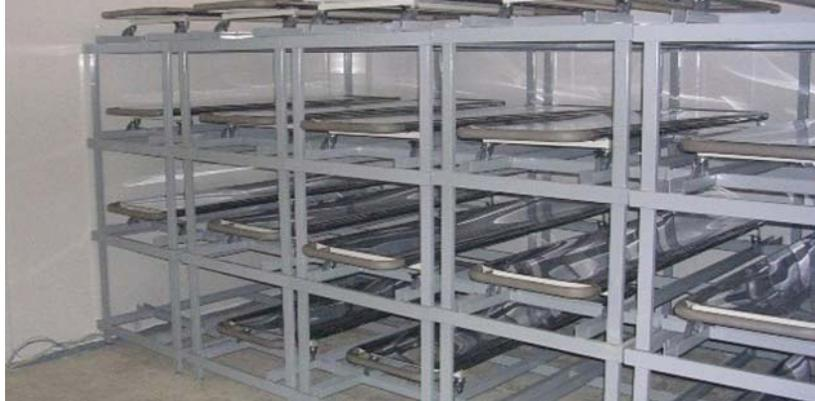
Секции рамного сварного стеллажа на 4 или 5 ярусов, на 4 или 5 мест из стали в порошковой окраске или НЖС. Размер (ДхШхВ): 2000х800х2000 или 2000х800х2500 мм. Размер рельсы 200х60х30 мм., ширина рельс 550 мм. Секции комбинируются между собой по ширине кратной 800 мм. и скрепляются в единую жесткую конструкцию. Вес 90 кг. Стеллаж совместим с подъемниками, поддоном и подкатной тележкой марки "LTB". Сертификат соответствия ЕАС № ЕАЭС\_N\_RU\_Д-РУ.НВ29.В.07398-20.
